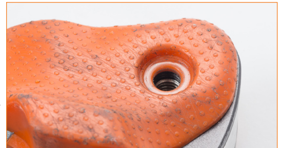
Regolatore con vite mancante. ⚠ Sostituire con l'apposita parte di ricambio. Inserirsi del frena-filetti debole nel foro e avvitare fino a completo serraggio.
