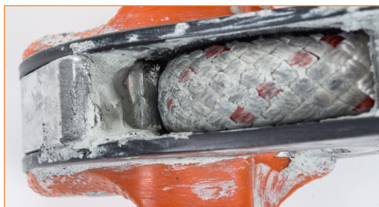
Regolatore con camma bloccata in seguito ad accumulo di materiale estraneo.
