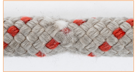
Cordino con anima danneggiata. Questo danno si rileva meglio al tatto anche se è possibile notare un leggero assottigliamento del cordino.
