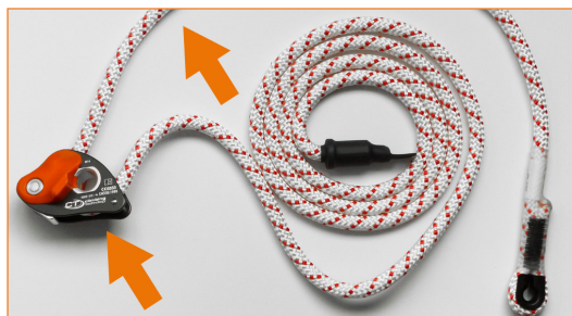
Connettore del regolatore e protezione della corda mancante. ⚠ In assenza di altri difetti, sostituire con le apposite parti di ricambio.
