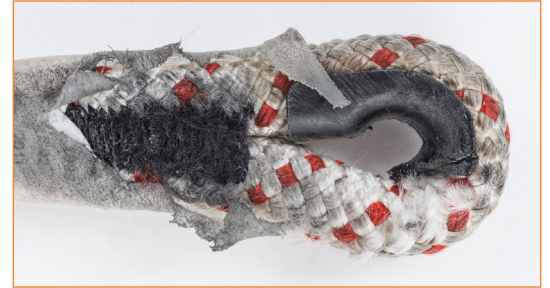
Asola terminale danneggiata: redancia e guaina termoretraibile parzialmente mancanti, cucitura e cordino usurati ed etichetta illeggibile.
