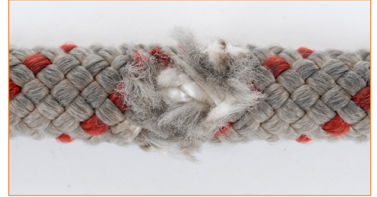
Cordino con calza danneggiata: è visibile l'anima della corda.
