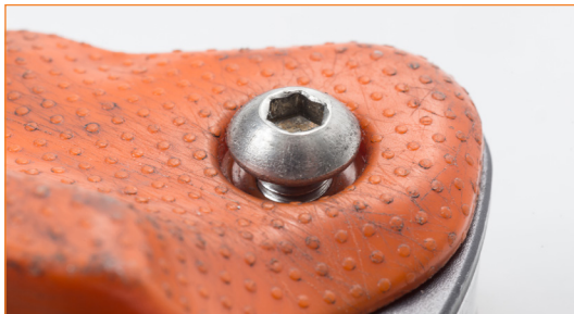
Regolatore con vite allentata. ⚠ Inserirsi del frena-filetti debole e riavvitare fino a completo serraggio.
