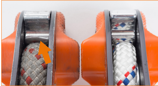
Camma del regolatore molto usurata: si noti la differenza fra un dispositivo nuovo (a destra) e uno con camma usurata (a sinistra).
