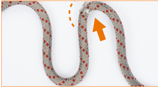
Cordino danneggiato. Si noti la differenza di curvatura fra la zona intatta (curva regolare, in basso a sinistra) e quella danneggiata (curva spezzata, in alto a destra).
