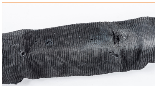
Evidenti bruciature sulla guaina di protezione. Attenzione! Verificare attentamente l'intera lunghezza del cordino: i danni visibili sulla guaina potrebbero essere presenti anche su di esso.
