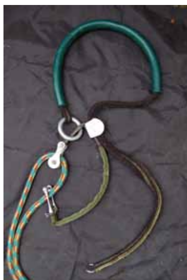
Ancoraggi: falsa forcella regolabile (ropeguide)
