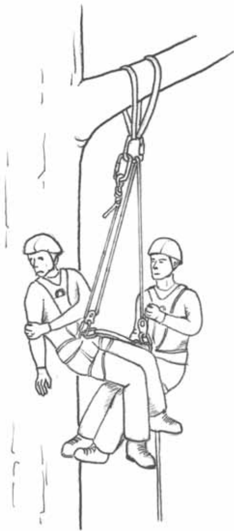
Recupero con sollevamento: impiego di carrucola di rinvio per moltiplicare la forza di sollevamento
