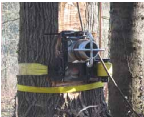
Frizioni: GRCS con cilindro in alluminio e piastra di fissaggio inserita nel fusto
