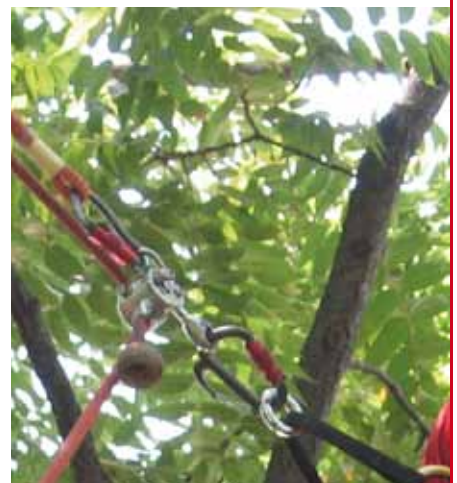
Dispositivo di frizione per sistema a corda doppia (particolare)
