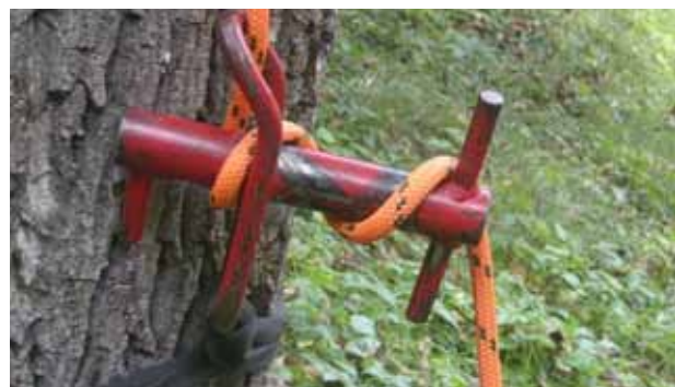
Frizioni: cabestan volant (port a wrap)
