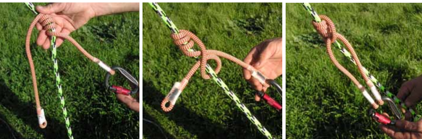
Sequenza di esecuzione del nodo distel
