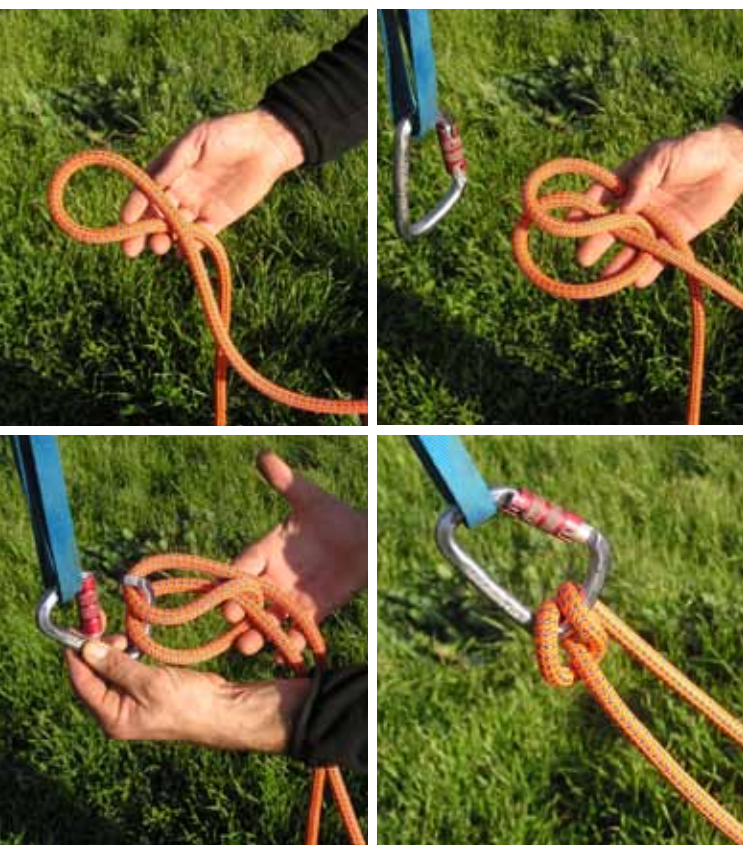
Sequenza di esecuzione del nodo mezzo barcaiolo
