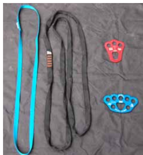
Ancoraggi: a sinistra anelli di fettuccia chiusi, a destra moltiplicatori di ancoraggio
