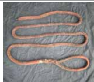
Sling per ancoraggio asolata, a treccia singola
