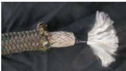
Corda per ritenzione a doppia treccia: visibile l'anima a trefoli intrecciati
