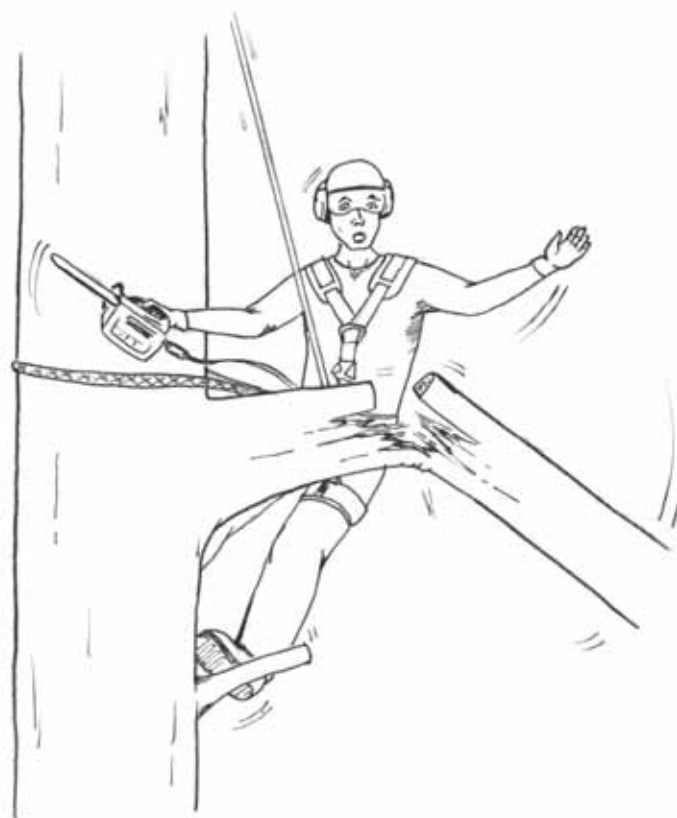
Scosciatura causata da tecnica di taglio non adeguata
