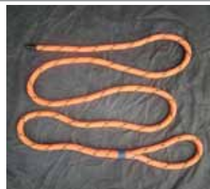
Sling per ancoraggio asolata, a doppia treccia
