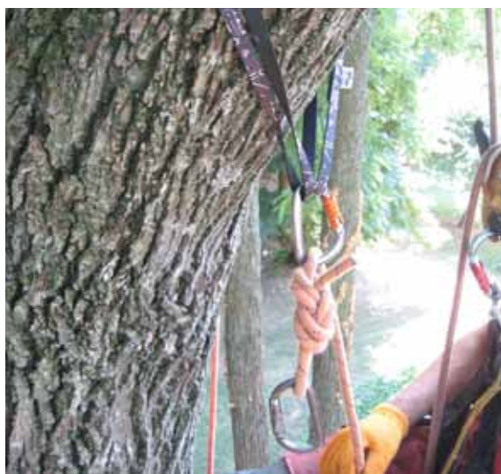
Ancoraggio su fettuccia per il recupero del ferito con sollevamento
