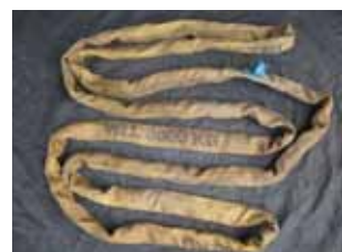
Fascia di ancoraggio ad anello
