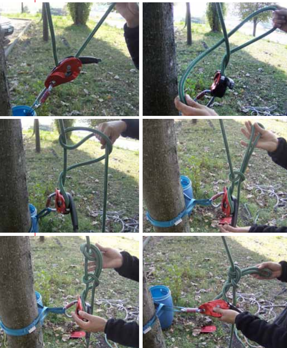
Sequenza di esecuzione di asola e contro asola
