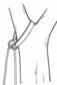
Ancoraggio per corda doppia: corda su falsa forcella. (Soluzione 3)
