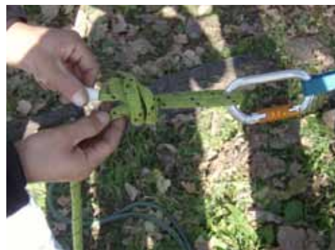
Sequenza di esecuzione del nodo doppio inglese con asola
