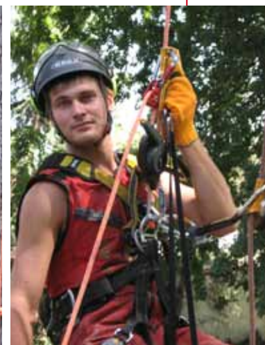
Sequenza di risalita con discensore e maniglia, con carrucola
