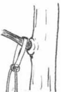
Punti di ancoraggio non corretto
