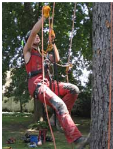
Sequenza di risalita con discensore e maniglia, senza carrucola
