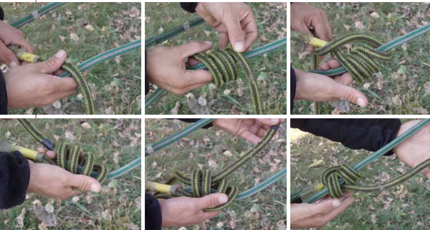
Sequenza di esecuzione del nodo bellunese
