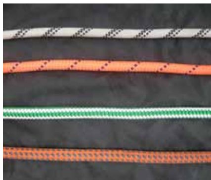
Funi (DPI), dall'alto: kern mantle, diametro 10,5 mm; kern mantle, diametro 11 mm; 16 trefoli, diametro 13 mm; doppia treccia 24 trefoli, diametro 11 mm
