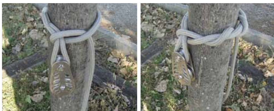
Sequenza di esecuzione del nodo boscaiolo
