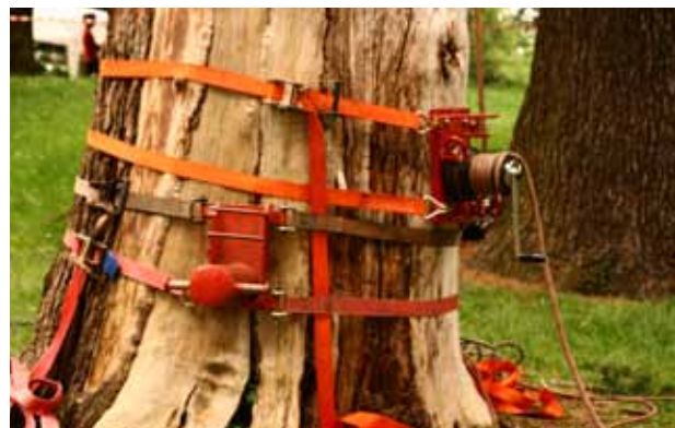
Frizioni: installazione con frizione fissa e paranco tipo winch
