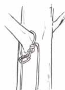
Ancoraggio per corda doppia: corda doppia strozzata su una forcella naturale. (Soluzione 2)
