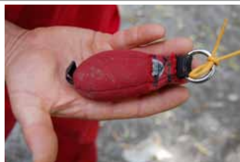
Nodo impiegato per legare il sagolino al pesino
