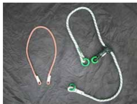
Ancoraggi: a sinistra cordino per treccia valdostana, a destra falsa forcella regolabile (multisaver)
