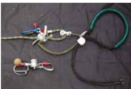
Lockjack, in basso a sinistra, e spiderjack associato a dispositivo di ancoraggio
